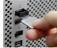
専用引抜ツールをまっすぐ引き抜いてキャップを取り外します。(専用ツールは回さずに引き抜きます)
