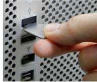
キャップの穴部分に専用引抜ツールを奥まで差し込みロックを解除します。
