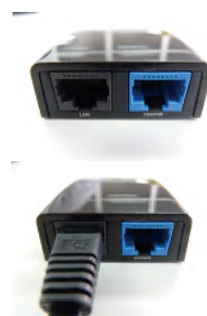
d. アクセスポイントにLANケーブルを接続します。 このとき、左記画像の左側「LAN」と記述された部分にカチッと音がするまで接続して下さい。
