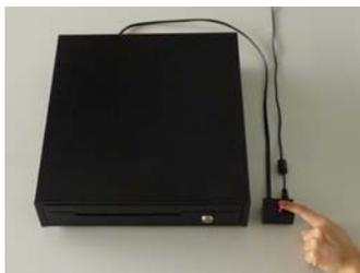
DC ジャックに 24V タイプの AC アダプタのプラグを接続、DKD モジュラジャックにキャッシュドロワのモジュラケーブルを接続します。
