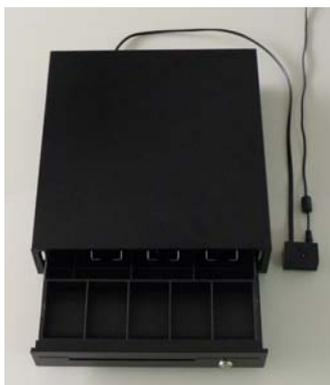
AC アダプタでドロワオープンモジュール本体に電源を供給すると、ドロワオープンモジュール本体が起動し、赤色 LED が点灯します。
