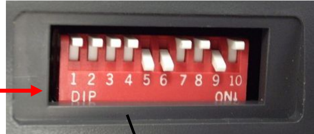
ピアノスイッチ型ディップスイッチの設定例
