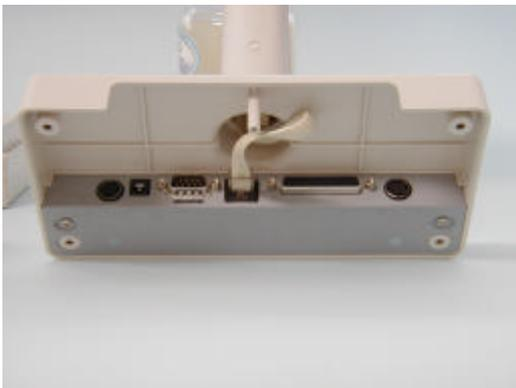
で固く押し込みますと、支持ポール内部でケーブルが固定され、その状態で表示ユニットを回転すると、コネクタに無理な力がかかり、接触不良をおこす場合があります。
