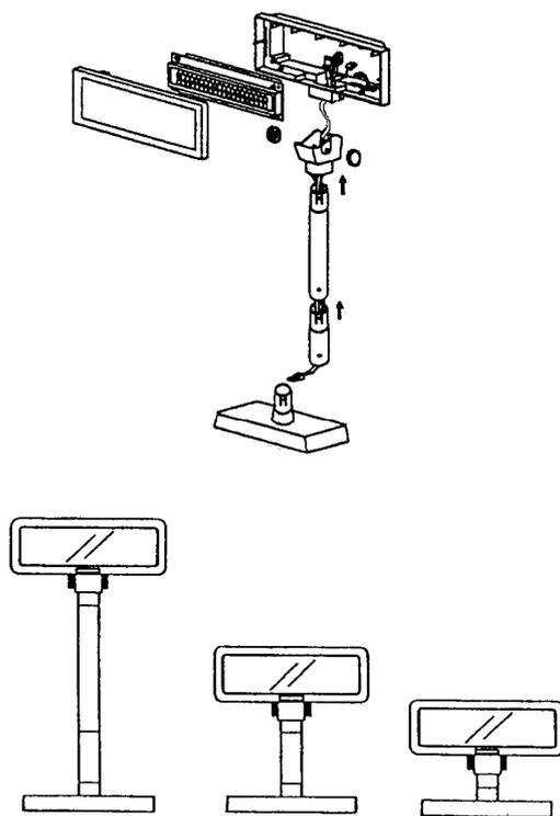
表示ユニットから出ている信号ケーブル(先端にモジュージャックのついたケーブル)は支持ポールを最大長に接続した状態にあわせていますので、支持ポール接続が短い場合、ケーブルが余ります。ケーブルを支持ポール内に収容する場合は、ケーブルに遊びができるようにしてください。表示ユニットを回転した際、ケーブルがユニットに引っ張られます。ケーブルを折りたたんで固く押し込みますと、支持ポール内部でケーブルが固定され、その状態で表示ユニットを回転すると、コネクタに無理な力がかかり、接触不良をおこす場合があります。
